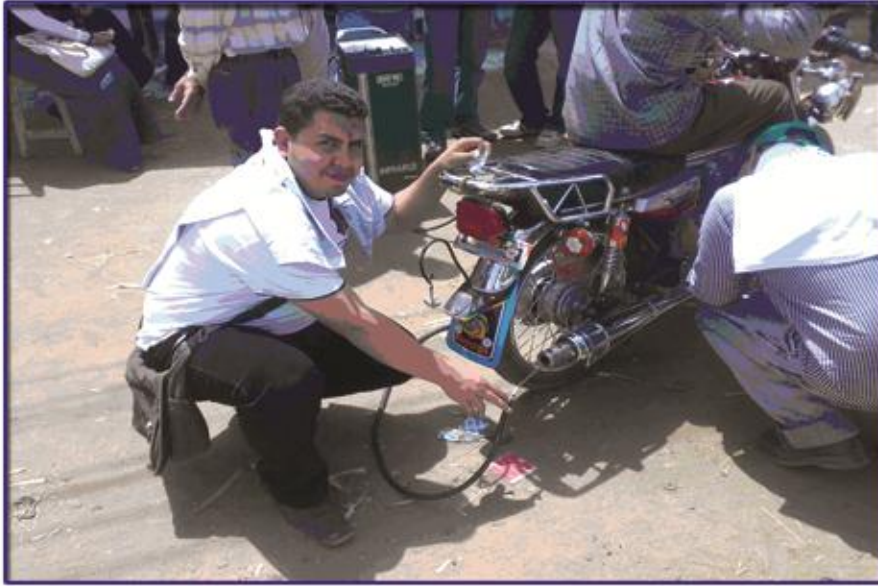
اعضاء قافلة رصد الملوثات البيئية يقومون بقياس عوادم احدى المركبات البخارية لفحصها وتحليلها.
