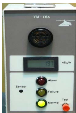
Figure (3.21); (Area Monitor unit) UMA unit
