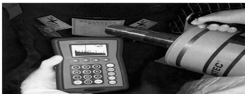
Figure (2.2); Portable HPGe multichannel analyzer(ORTEC)
